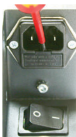
FIGURE 14 : REMPLACEMENT DU FUSIBLE PRINCIPAL
