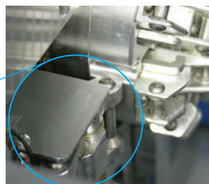
FIGURA 11: POSIZIONE BASE DELLA SLITTA DI SBLOCCAGGIO
