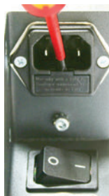
FIGURA 14: CAMBIO DEL FUSIBLE PRINCIPAL
